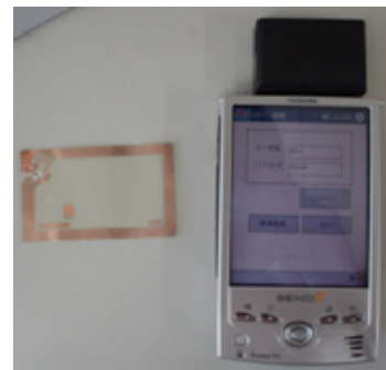
図13 RFIDタグ、リーダ、PDA
