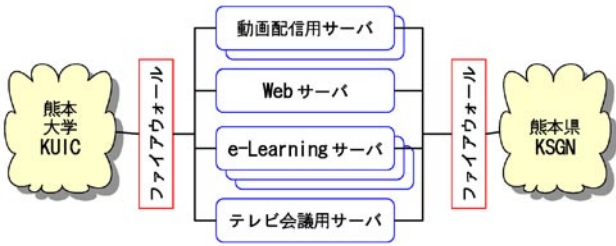
図1 LINK構想におけるネットワーク接続サーバシステム
