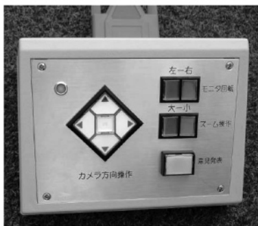
病院側端末が持つコントローラ
